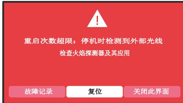
图 79：错误显示屏“LMV6 处于故障中”
